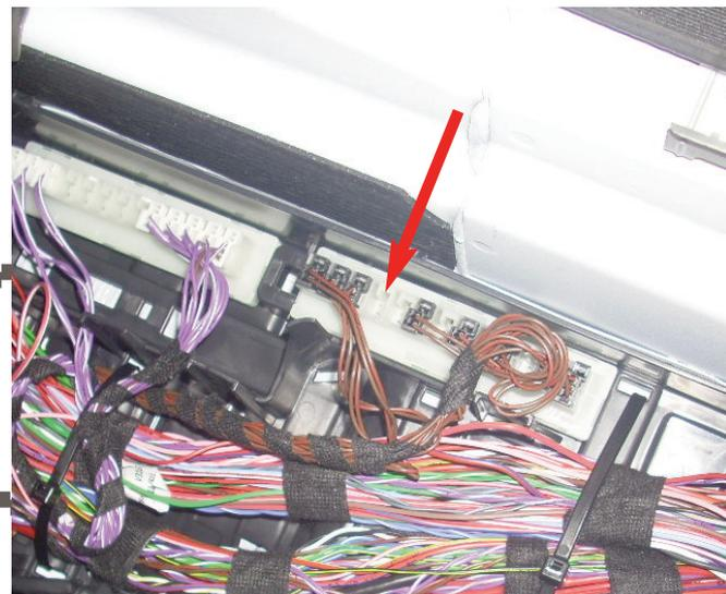
**N.B. Eeguire questa connessione solo con batteria vettura scollegata. Una errata connessione di questi cavi, può compromettere il funzionamento della vettura.**
